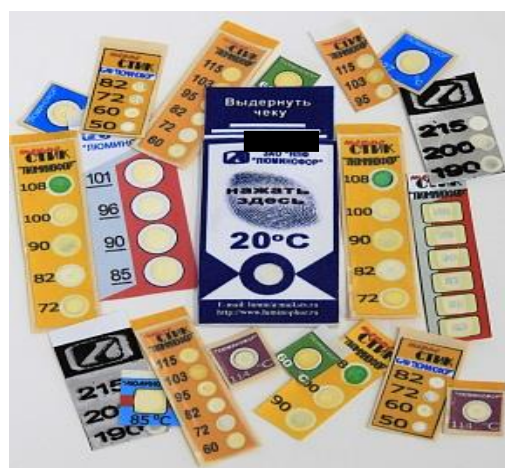
Рисунок 13. Примеры термоиндикаторных наклеек различных производителей
